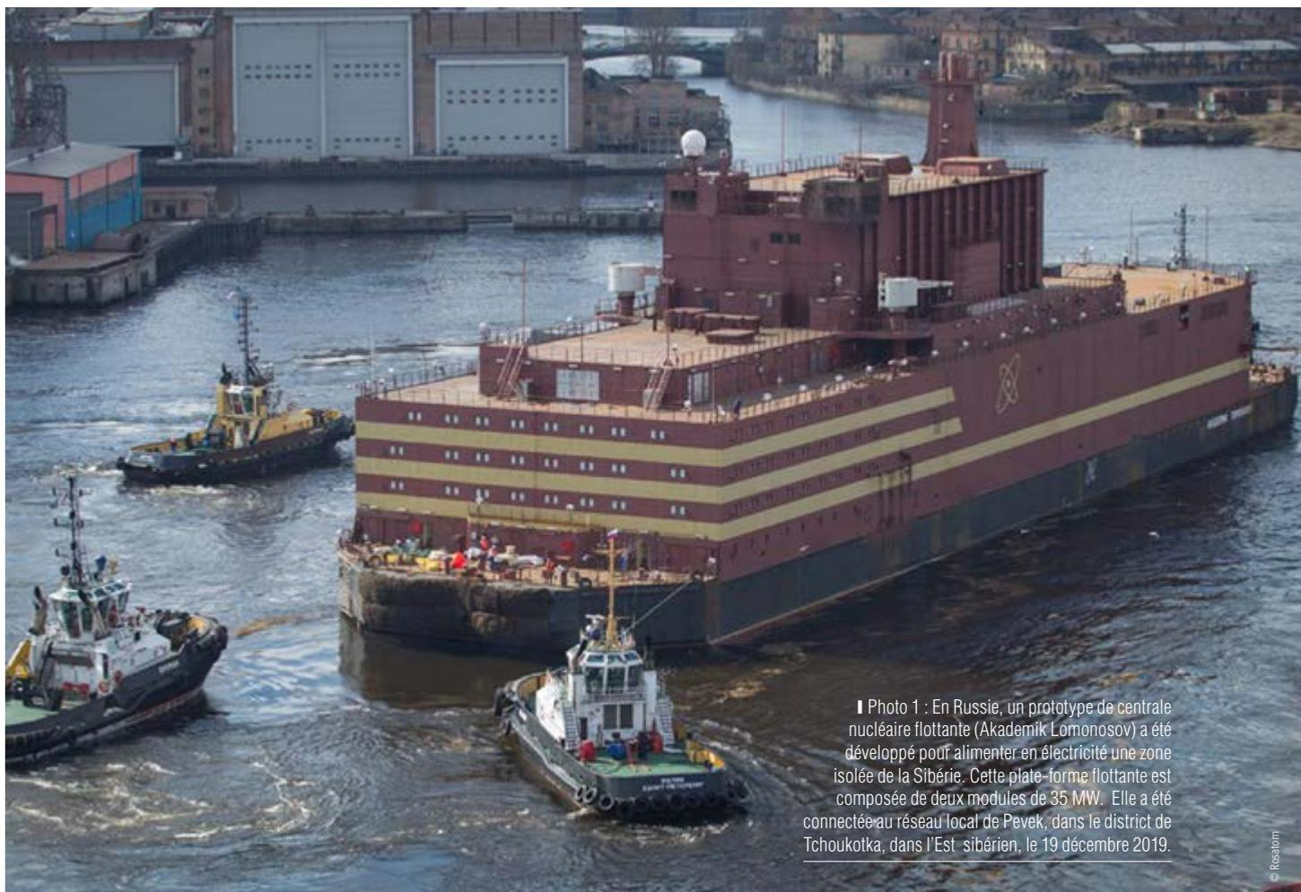
Photo 1 : En Russie, un prototype de centrale nucléaire flottante (Akademik Lomonosov) a été développé pour alimenter en électricité une zone isolée de la Sibérie. Cette plate-forme flottante est composée de deux modules de 35 MW. Elle a été connectée au réseau local de Pevek, dans le district de Tchoukotka, dans l'Est sibérien, le 19 décembre 2019.
