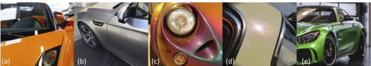
Figure 2 : L'industrie automobile est motrice d'innovation dans le domaine de l'apparence. Les peintures, initialement uniformes et brillantes (a), deviennent métalliques dans les années 80 (b). Elles sont aujourd'hui goniochromatiques (c), scintillantes (d) ou satinées (e). Les caractériser nécessite d'aller au-delà de la couleur.
